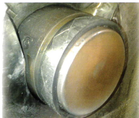
Pistone diam 160 mm, dopo 24.000 iniezioni. Produzione blocchi motore 4 cilindri
